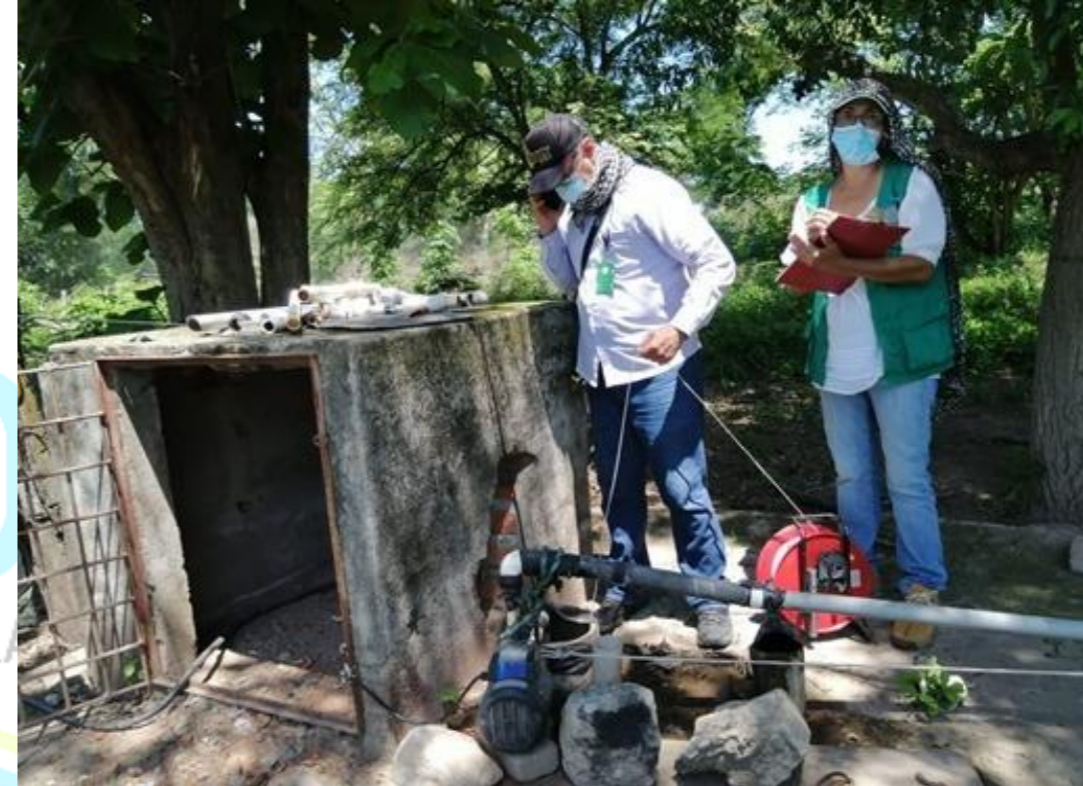
Monitoreo de niveles de aguas subterráneas pozos profundos
