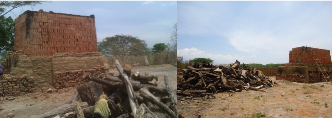
Figura 17. Imagen de los hornos pampa abiertos y la leña utilizada como combustible para la cocción de los ladrillos.
