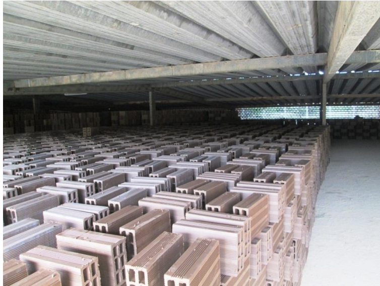
Figura 25. Bodega térmica para secado natural
