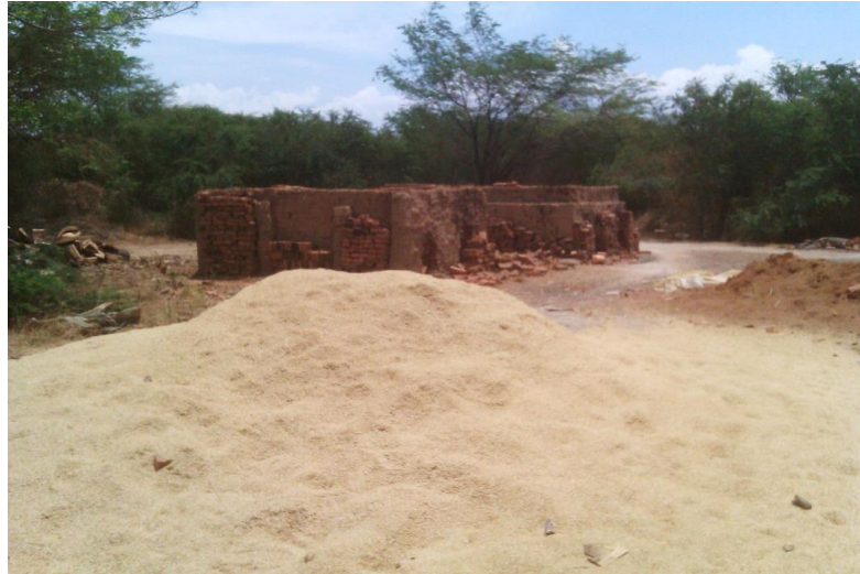
Figura 21. Cascarilla de arroz y aserrín utilizados como parte de la mezcla para la producción de ladrillos
