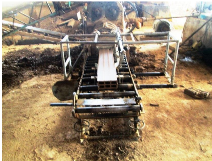
Figura 23. Salida de la arcilla moldeada de la extrusora
