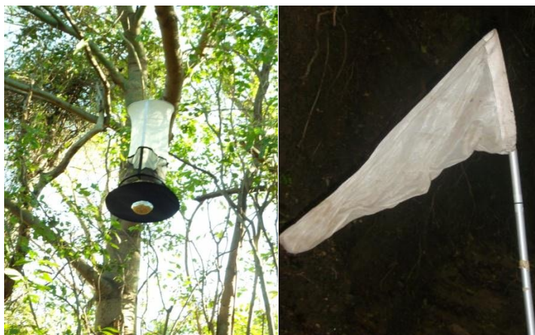
Figura 1-10. Método de Captura Indirecto con Van Somer-Rydon (Izquierdo) y Captura Directa con Jama Entomológica (Derecha).
