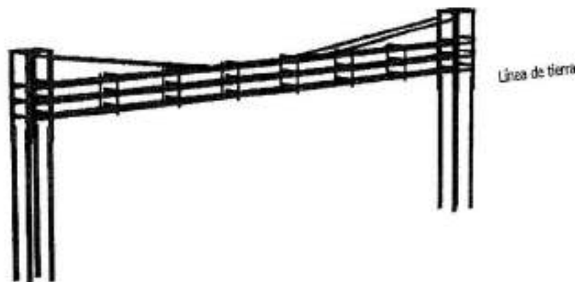
Figura 14. Estructura de soporte de cableado tipo 1. Fuente: EIA SPK LA MATA 2023
