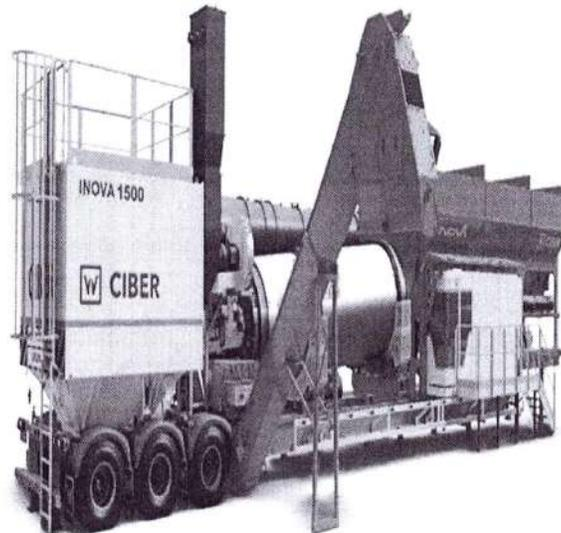
Se utilizará una planta de asfalto móvil continua INOVA 1500 CIBER modelo 2022. La cual es la que se encuentra en proceso de permiso de emisiones. El proceso productivo de esta modalidad de planta se inicia con la dosificación de agregados a través del pesaje dinámico individual de éstos. La etapa siguiente es el secado de los agregados en horno rotativo con llama directa en contra corriente. Una vez secos, los agregados pasan para un mezclador continuo
