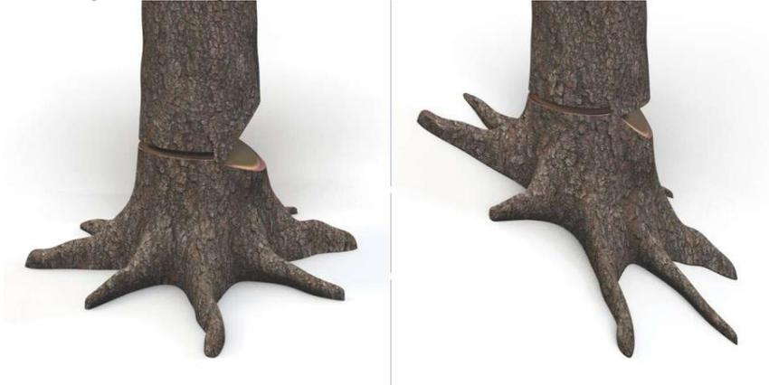
*Ilustración 1. Corte Direccional*
