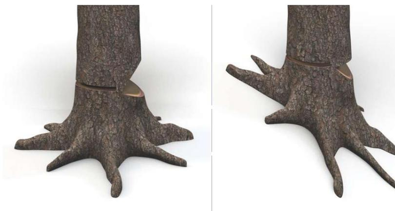
Ilustración 1. Corte Direccional
