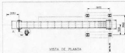
*Sección Banda Transportadora - Trituradora.*
