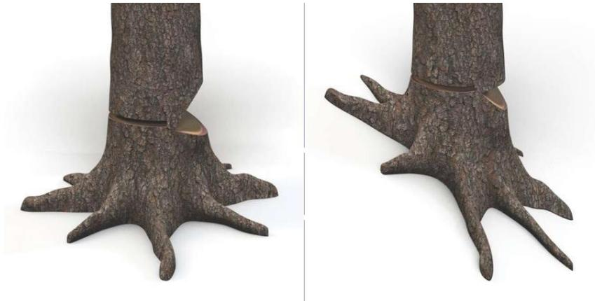
Ilustración 1. Corte Direccional
