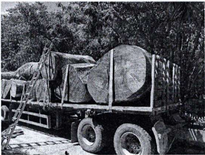
Fotografía 2. Proceso de cubicaje de la madera de la especie Algarrobo (Albizia saman), que correspondieron a 35,021 metros cúbicos aproximadamente. Fuente: (Fundación ORNIAT, 2024b)
