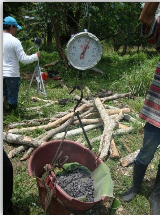
Figura 16. Pesado final de los restos del material vegetal (cenizas y carbón)
